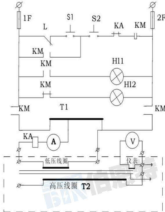
1-2F 熔断器 KM 交流接触器 KA 过流继电器 L 零位开关 H11 合闸指示
