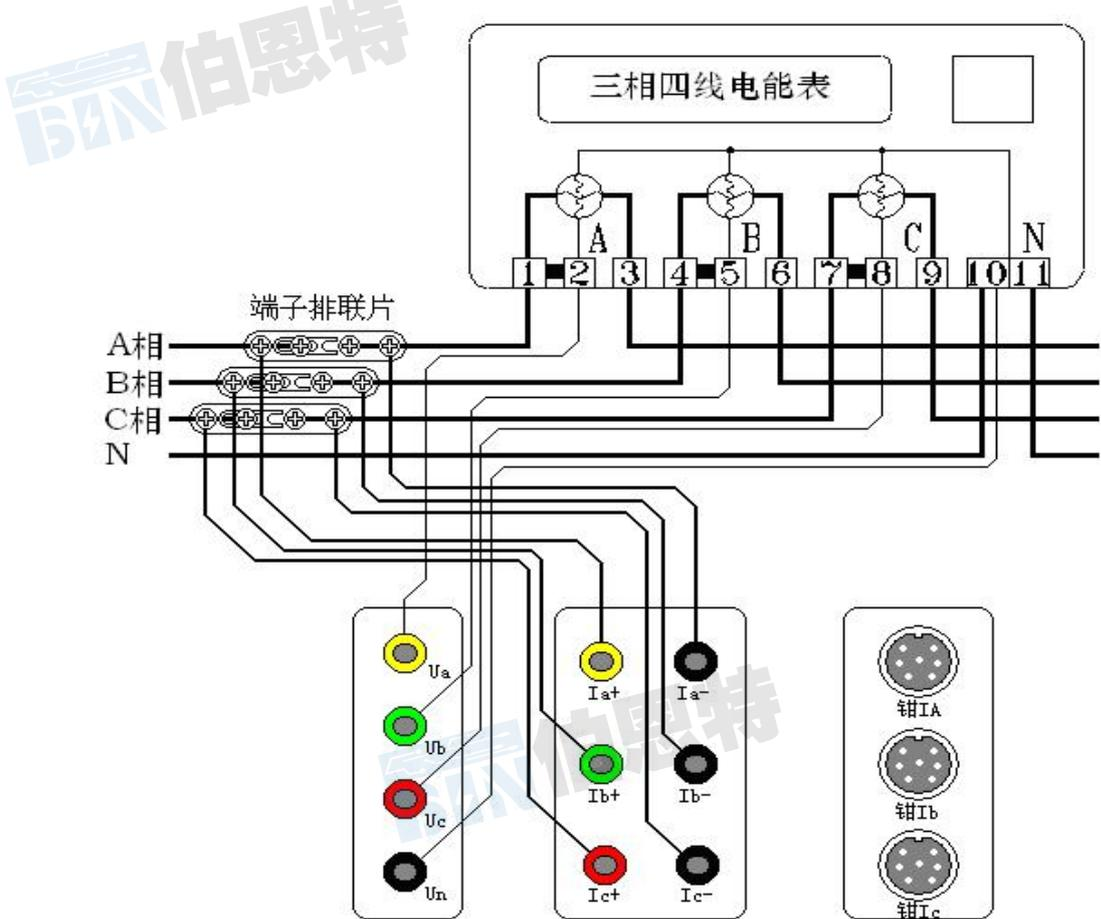
图二十二、三相四线直接接入测试
