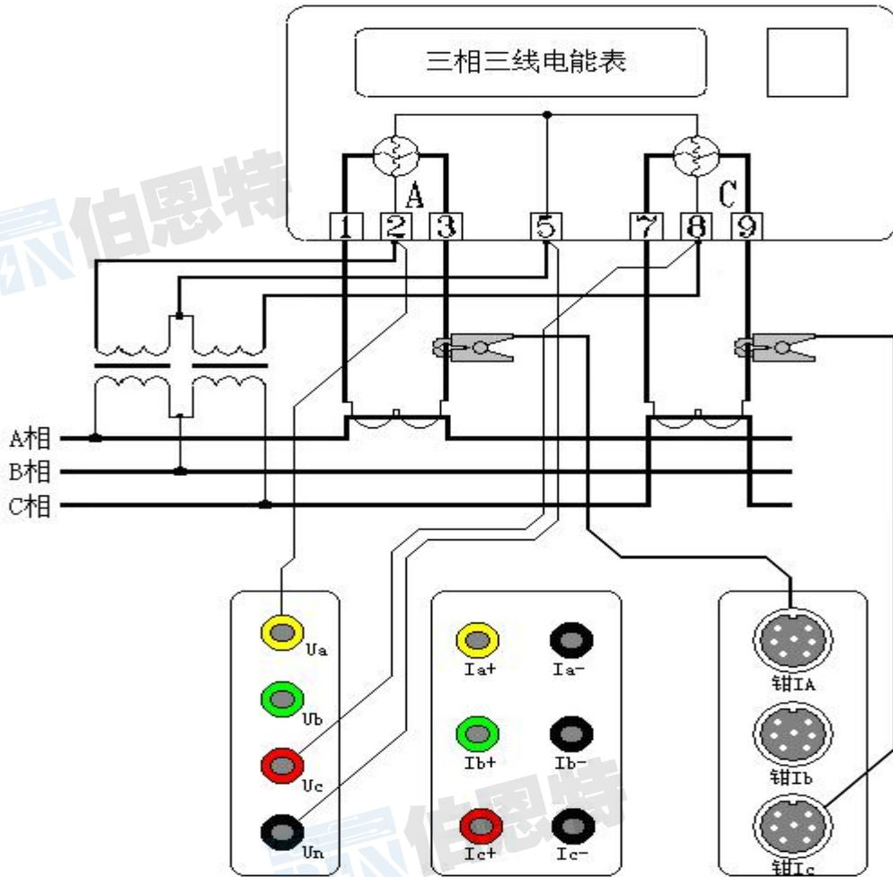
图二十三、三相三线高压计量表经钳表接入测试
