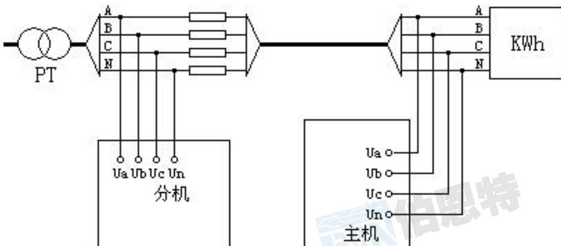
图二十、四线压降测试接线
