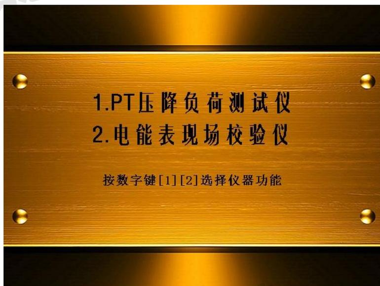
图中提示：选项 1.PT 压降负荷测试仪，选项 2.电能表现场校验仪。通过按数字键[1]和[2]进行选择(或者按 F1、F2 功能键也可)。
