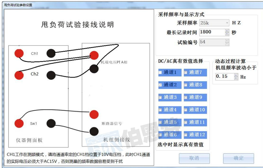
图 34 甩负荷试验参数设置
