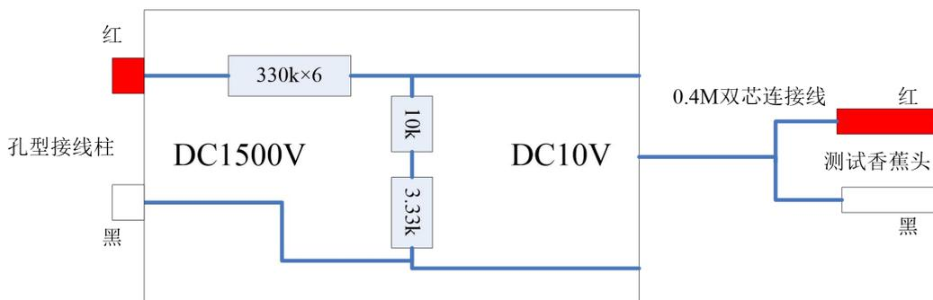
图 1 DC1500V/DC10 变换器电气原理图
