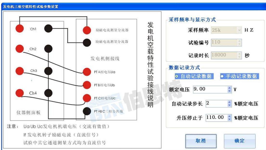
图 30 空载特性试验参数设置
