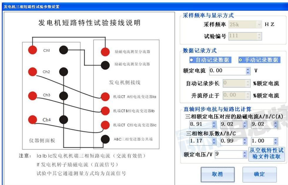
图 32 短路特性试验参数设置
