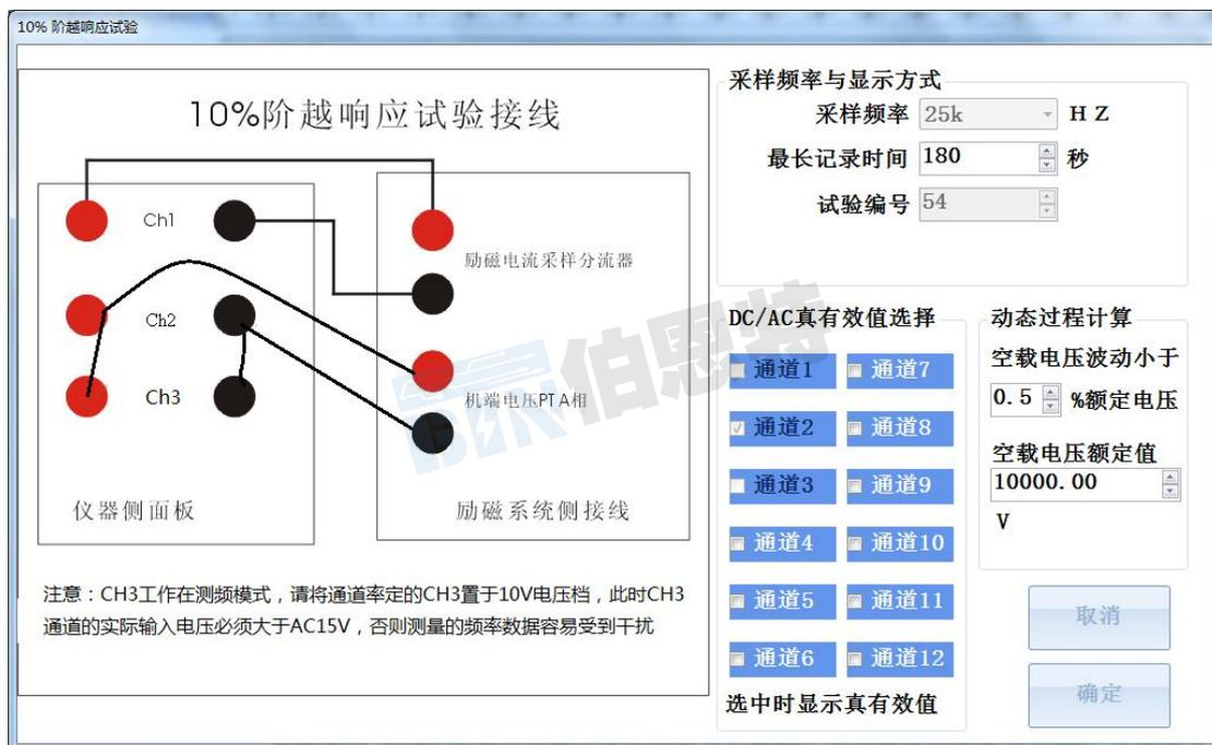
图 36 励磁系统 10%阶跃试验参数设置
