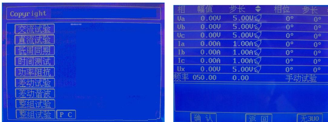
主菜单有 9 项可选项（如下左图）。旋动旋转鼠标将光标移到某一项上，按下旋钮即进入此项试验。
