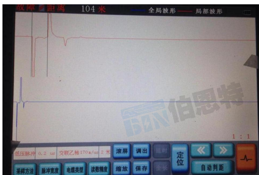
图二：低压脉冲短路波形
