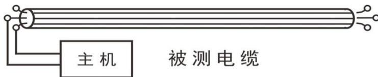
低压脉冲法接线图
