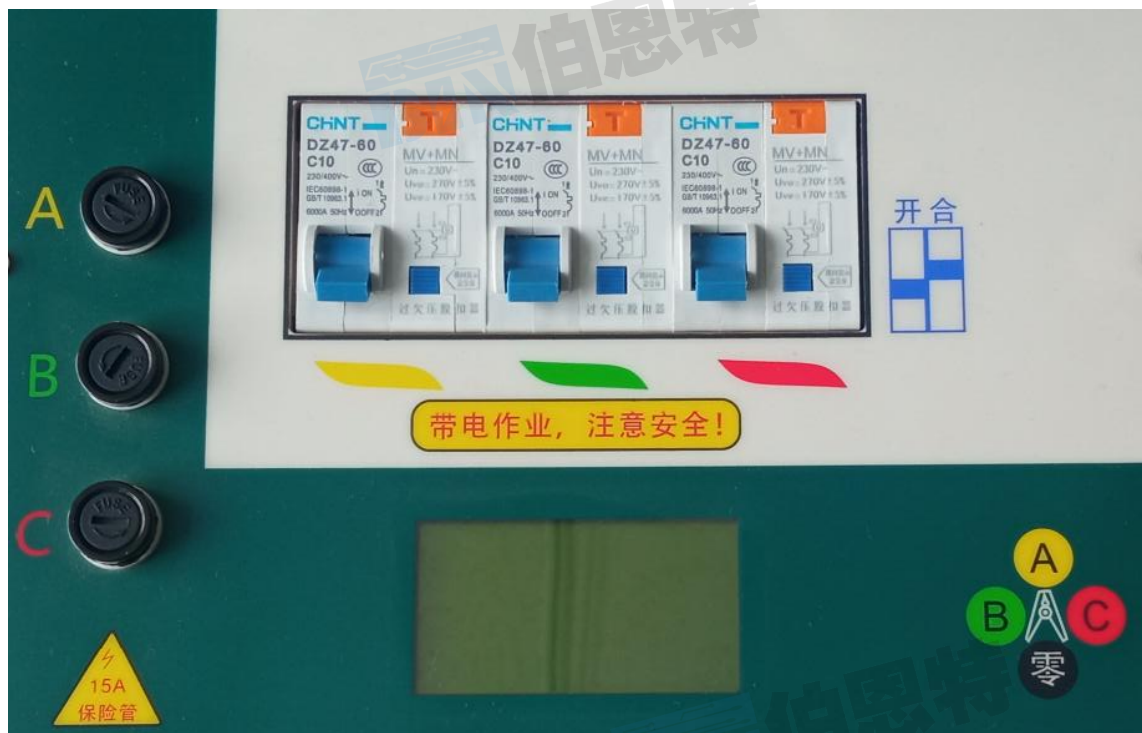
图3 配变台区识别仪发送器面板示意图
