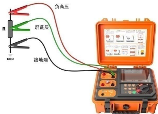
图 7-8 绝缘电阻测量接线（带屏蔽）
