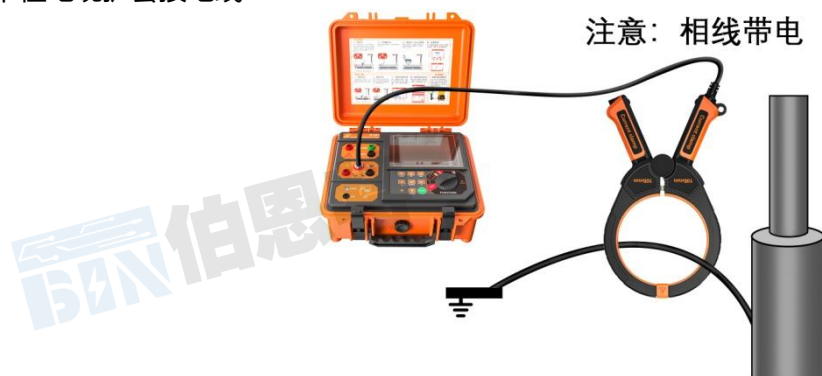
图 5-19 运行电缆卡钳耦合方法 2（卡电缆接地线）
