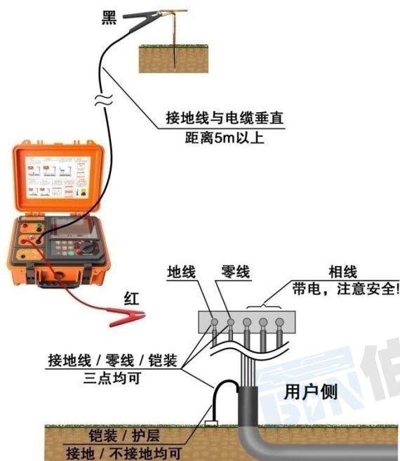
图 5-22 运行电缆零线 / 地线 / 护层注入法
